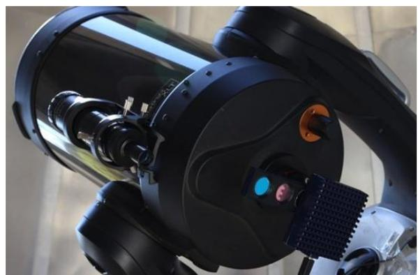
**Figura 1: Câmera CCD com filtros LRGB usada na obtenção de astrofotografias e sua devida montagem ao telescópio.**
